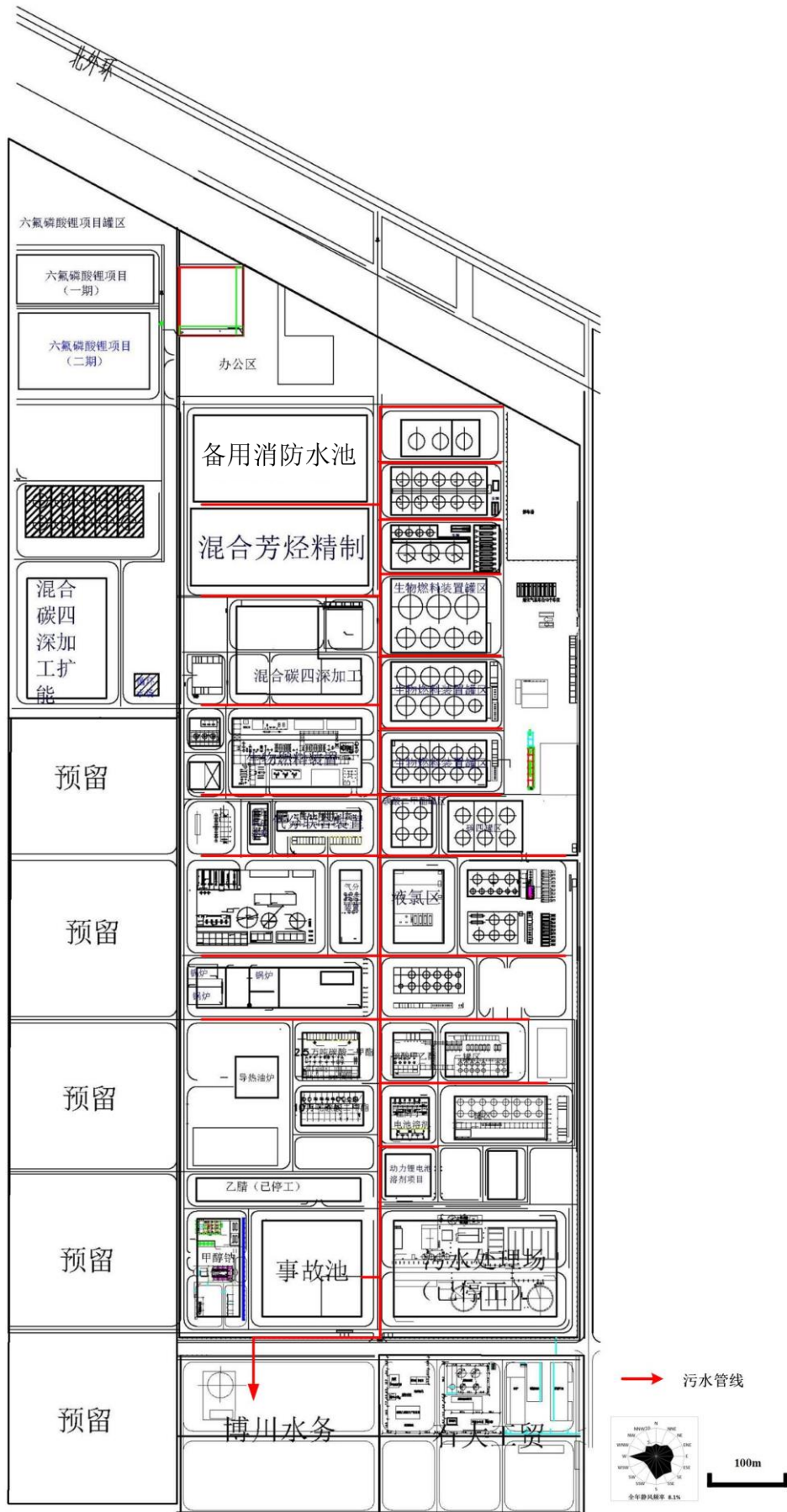
附图 7 污水管网及排放去向图
